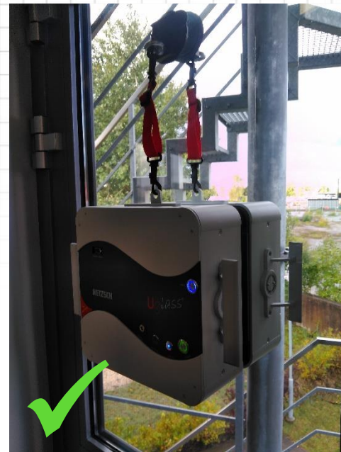
Logu/durvju siltuma caurlaidības mērījumi
